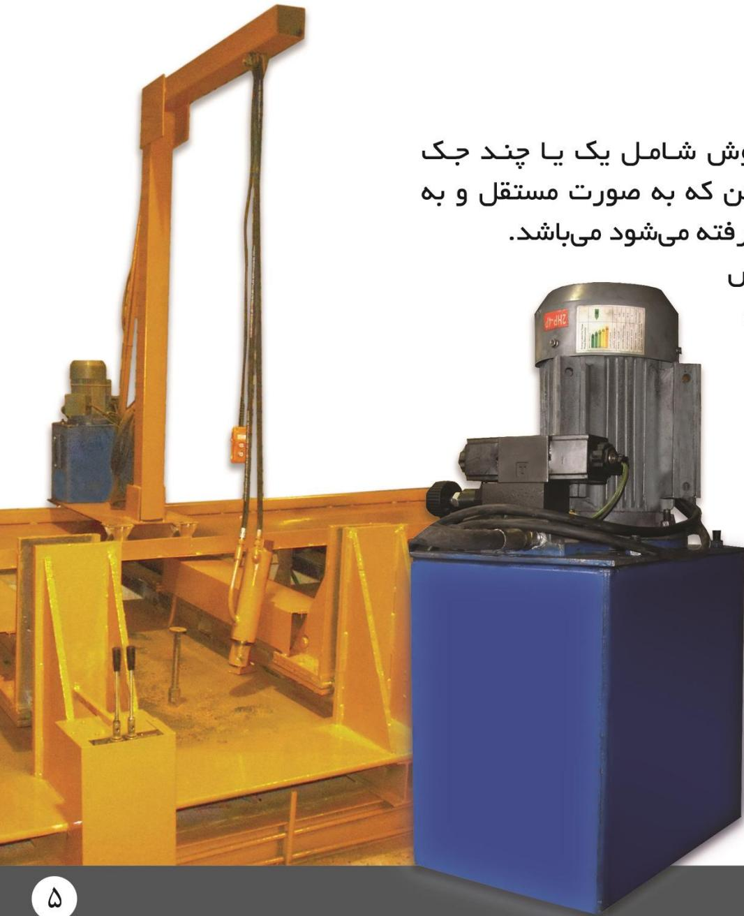
۲. سیستم نصب درپوش شامل یک یا چند جک هیدرولیک با قدرت ۱۵ تن که به صورت مستقل و به موازات میز اصلی به کار گرفته می‌شود می‌باشد.
